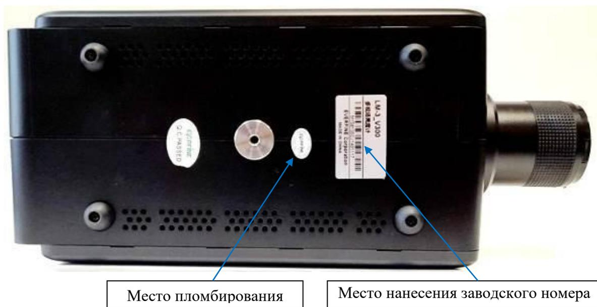
Рисунок 2 – Схема пломбировки от несанкционированного доступа (вид снизу)
