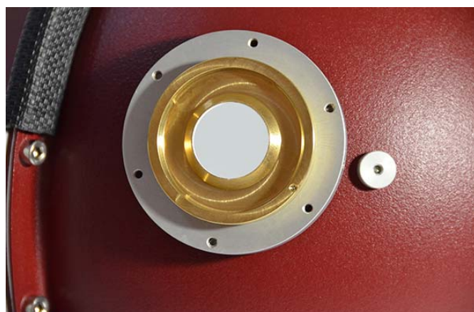
Der Bajonett Anschluss bietet eine präzise und einfache Befestigung des BTS256-LED Testers an der Ulbrichtschen Kugel
