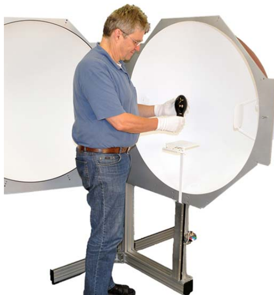
Ulbrichtsche Kugel mit großem Durchmesser erweitern das Anwendungsgebiet des BTS256-LED Testers
