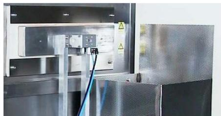
Поддон из нерж. стали с функцией автоматического сброса горячего образца в охлаждающую воду
