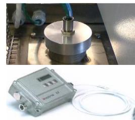
Измеряет температуру на поверхности образца. Тест завершается при достижении заданной температуры
