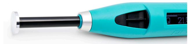
В сочетании с особенностью SilverSchmidt получать результат не зависящий от угла измерения делает его идеальным прибором в целях применения на ранних сроках твердения, например определение, когда снимать опалубку.
