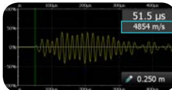
Рассчитывает скорость ультразвукового импульса для испытываемого материала.
