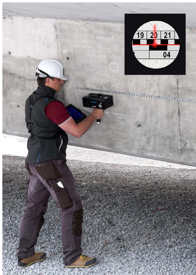
Позиционный монитор отображает текущее положение датчика
