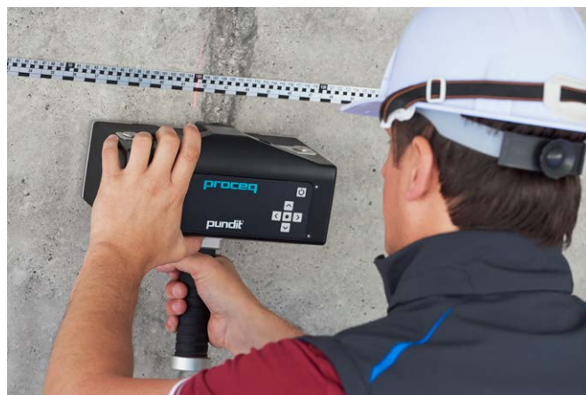
Безошибочное позиционирование с помощью ленты Pundit Live
