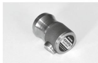
**Одноэлементный** преобразователь на 2,5 МГц более компактен, работает от одного кабеля и, следовательно, больше подходит для измерений в ограниченных пространствах.
