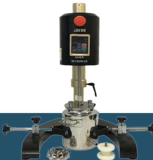
BEVS 2501/S — портативная диспергирующая машина с простым управлением. Он оснащен встроенным перемешивающим валом, регулирует скорость двигателя с помощью преобразователя частоты, напрямую отображает текущую рабочую скорость и является хорошим выбором для исследований и разработок, лабораторных и полевых испытаний.
