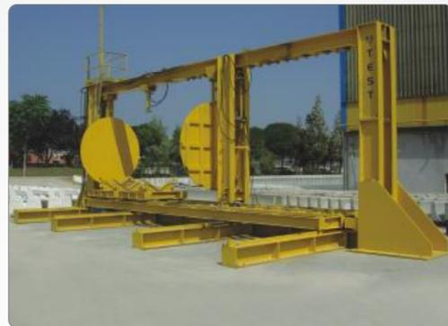
UTSP-0250 Оборудование для тестирования бетонных труб на водонепроницаемость
