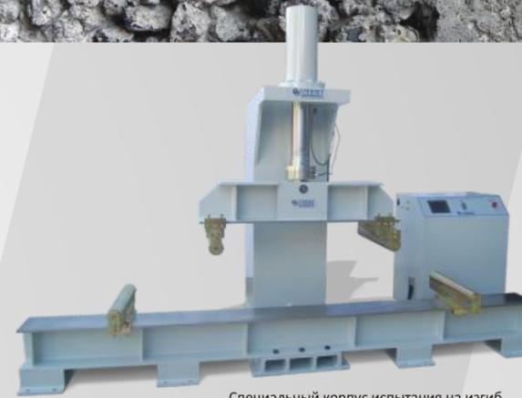
Специальный корпус испытания на изгиб
