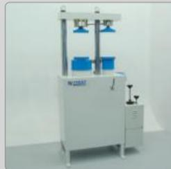
UTCM-6421 Полуавтоматический пресс (с мотором) на изгиб/сжатие цемента 15/250 kN
