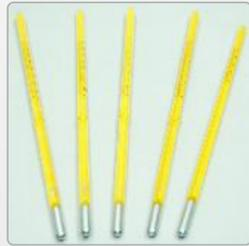
Стеклянный термометр вискозиметра
