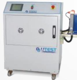
Усовершенствованные автоматические силовые гидростанции с сервоконтроллером, с клапаном пропорциональности и сервоклапаном ( для управления 2 или 4 разными корпусами тестирования)
