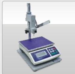
UTCM-0064 Установка определения времени удобоукладываемости закали/затвердевания
