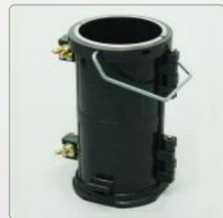
Цилиндрические формы корпус пластик-дно сталь или стальные
