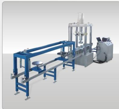
Установка статического испытания железнодорожных бетонных шпал и опор
