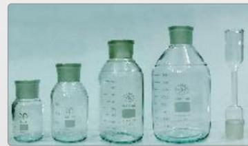
Пикнометр (бутылочного типа) с двумя закрывающимися горловинами
