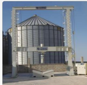
UTSP-0200 Пресс для тестирования бетонных труб, 1000 kN, без прицепа
