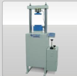
UTCM-6321 Полуавтоматический пресс (с мотором) на сжатие цемента 250 kN
