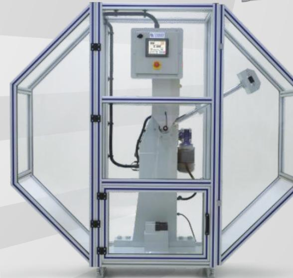
Автоматическое ударное устройство
