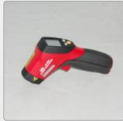
Цифровой лазерный термометр
