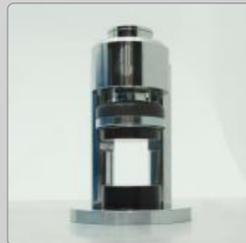
UTCM-0121/A Тестовый аппарат на сжатие ASTM, для цементного раствора в форме куба 50 мм (2")
