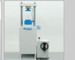
UTCM-6310 Ручной испытательный пресс на сжатие цемента 250 kN
