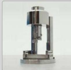
UTCM-0120/A Тестовый аппарат на изгиб ASTM, для цементных растворов в форме призмы 40x40x160 мм
