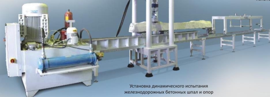
Установка динамического испытания железнодорожных бетонных шпал и опор
