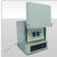
UTD-1462 Зольная печь 5 л., с цифровой системой контроля, макс. температура 1200°C
