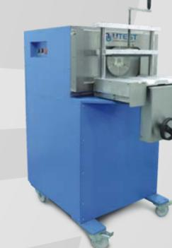
UTC-1035 Полуавтоматическая установка стачивания поверхности образцов,
