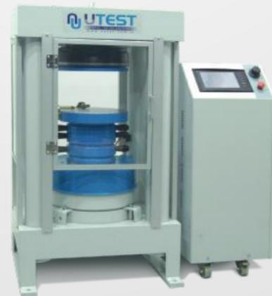
Автоматические испытательные прессы с 4 колоннами мощность 3000 kN, 4000 kN и 5000 kN
