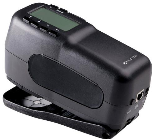
Эргономичный дизайн современного цветоизмерительного оборудования серии X-Rite 96x - ремешок на запястье, боковые захваты, высококонтрастный экран, емкий аккумулятор - позволяет использовать его в лаборатории, на производстве или в полевых условиях. Обладая превосходной межприборной согласованностью, удобен при работе с программами контроля качества, использующими несколько приборов.
