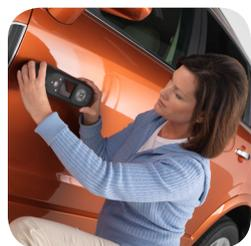
Новое поколение многоугольных приборов разработано для точного измерения цвета покрытий типа «металлик» и «перламутр», а так же других покрытий с особыми свойствами. Прибор обеспечивает 10 углов измерения и 2 угла освещения для получения уникального набора параметров каждого цвета.
