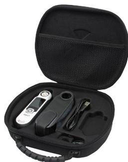
Портативный RM200QC помогает проводить оценку и сравнение цвета лабораторных образцов, комплектующих или готовой продукции с эталонными образцами в текстильной, лакокрасочной, химической промышленности, производстве пластмасс или других отраслях.
