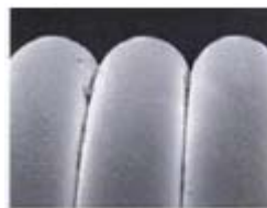
Другой стержень, изготовленный методом проволочной накрутки
